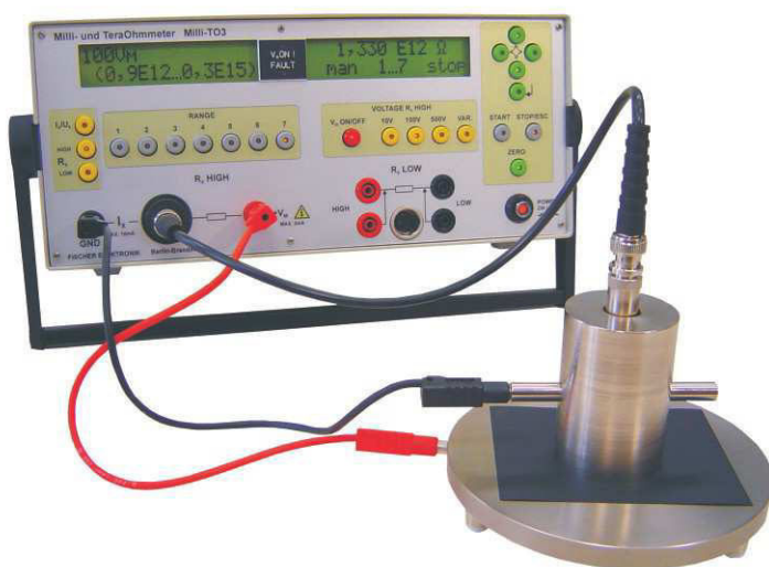
Измерение объемного сопротивления с использованием GP 14 (опция) и Milli-TO 3 (опция)
