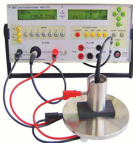
Измерение поверхностного сопротивления с использованием GP 14 (опция) и Milli-TO 3 (опция)
