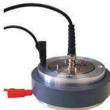
Измерение объемного сопротивления на пряже и волокнах
