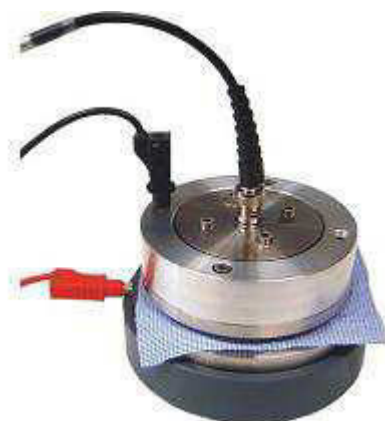
Измерение поверхностного сопротивления на заземленной опорной плите.
