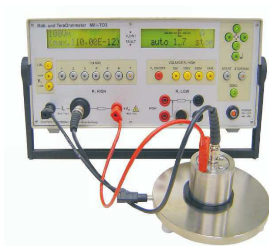
Измерение поверхностного сопротивления с использованием GP 14 (опция) и Milli-TO 3 (опция)
