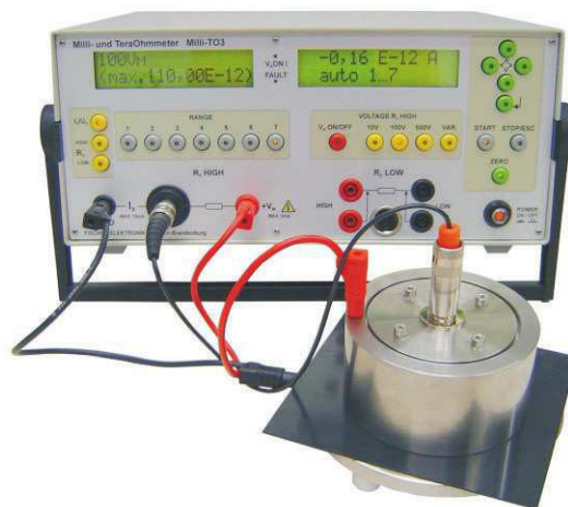
Измерение поверхностного сопротивления с заземленным столиком GP 14 (опция) и Milli-TO 3 (опция)
